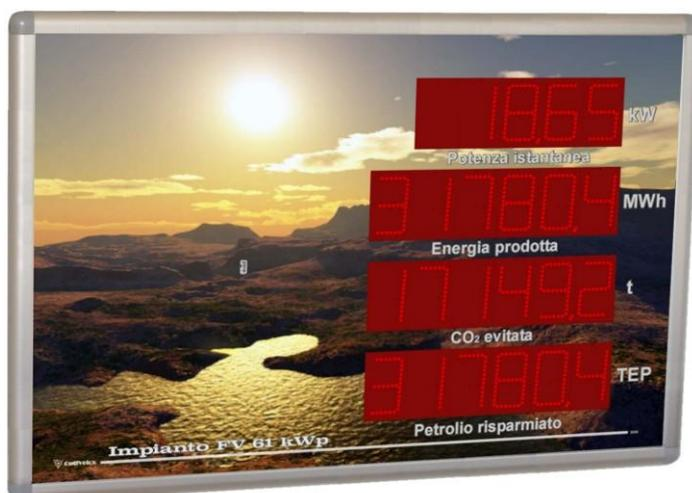
Il dispositivo SD04 appartiene alla famiglia denominata SmartDisplay, una serie di visualizzatori intelligenti integranti in un singolo apparecchio anche funzioni evolute di datalogger e controllo a distanza. SD04 permette di visualizzare tramite cifre giganti le grandezze principali di un impianto fotovoltaico e allo stesso tempo è in grado di archiviare i dati e renderli disponibili all'esterno tramite le principali modalità di comunicazione.
