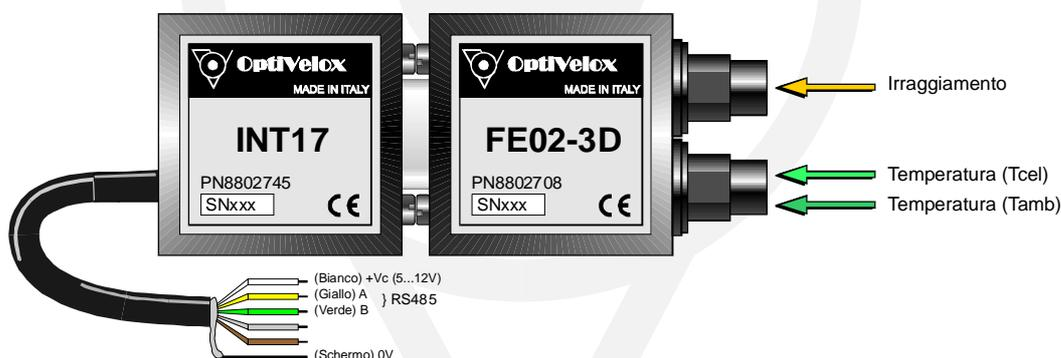
La stazione meteo viene offerta con collegamento seriale RS485 e può essere collegata direttamente ad un qualsiasi apparecchio della famiglia SmartDisplay (SD0X).
